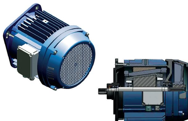
Motore elettrico asincrono trifase a 1 o 2 velocità a rotore conico e freno conico incorporato azionato da una molla elicoidale. Lo sblocco del freno viene provocato dallo spostamento assiale del rotore all'inserimento della tensione.
