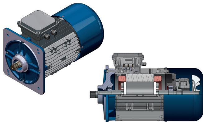
Motore elettrico asincrono trifase a 1 o 2 velocità a rotore cilindrico, con freno a dischi in C.C. Il motore a singola polarità, può essere azionato con inverter, per ottenere la velocità lenta richiesta oltre alle rampe di accelerazione e decelerazione.
