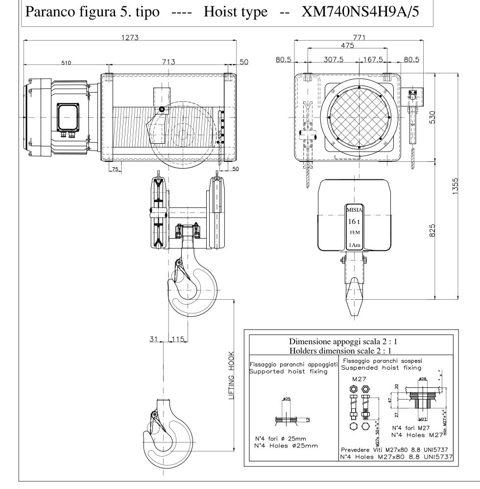
Reazioni massime e minime agli appoggi (valori statici) Maximun and minimun reaction on feet (static values)
