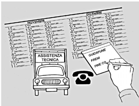
**ВСЕГДА** Соблюдать график проведения операций по техобслуживанию и записывать при каждой проверке имеющиеся замечания по проведенным действиям, особенно в отношении крюка, троса, тормоза и концевых выключателей.
