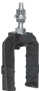
Serve a sostenere la guaina isolante e viene fissata alle mensole di sostegno, permette il libero scorrimento della guaina isolante durante la dilatazione. Le griffe di sostegno si fissano alla guaina a scatto con un passo di 1,33 mt. massimo.
