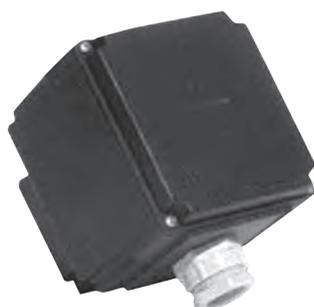
Il est monté à l'extrémité de ligne. Le couvercle arrière peut être retiré, assurant ainsi une installation plus facile. Il est équipé d'un presse-étoupe pour insérer le câble d'alimentation (diam. câble jusqu'à 26 mm.) ; il est fixé à la gaine à l'aide de 2 vis autotaraudeuses.
