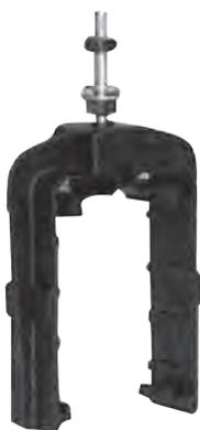
Elle sert de support à la gaine isolante et se fixe aux étagères de support, permettant le libre entraînement de la gaine isolante lors de l'expansion. Les griffes de support sont appliquées avec un pas maximum de 2 mètres.
