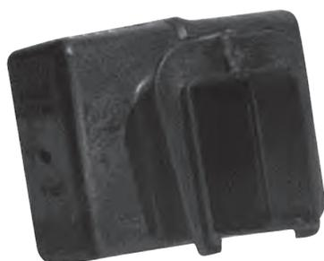
Il est utilisé pour raccorder deux sections de gaine où la jonction des conducteurs est également prévue. Il est utilisé dans le cas d'extensions de lignes existantes ou dans le cas de lignes particulièrement longues, où le conducteur ne peut pas être inséré dans une seule solution. Il est fixé à la gaine en correspondance avec la jonction à l'aide de 2 vis et des écrous M6.
