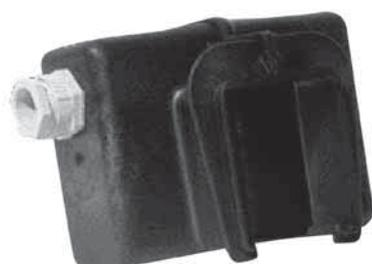
Il peut être monté n'importe où sur la ligne en correspondance avec la jonction de deux gaines. Il est équipé de presse-étoupes pour insérer le câble d'alimentation (diamètre câble jusqu'à 26 mm) et se fixe à la gaine à l'aide de 2 vis et d'écrous M6.
