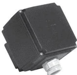
Il est monté à l'extrémité de ligne. Le couvercle arrière peut être retiré, assurant ainsi une installation plus facile. Il est équipé d'un presse-étoupe pour insérer le câble d'alimentation (diam. câble jusqu'à 26 mm.) ; il est fixé à la gaine à l'aide de 2 vis autotaraudeuses.
