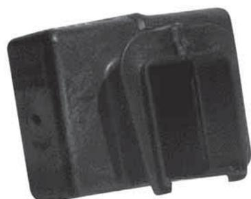
Il est utilisé pour raccorder deux sections de gaine où la jonction des conducteurs est également prévue. Il est utilisé dans le cas d'extensions de lignes existantes ou dans le cas de lignes particulièrement longues, où le conducteur ne peut pas être inséré dans une seule solution. Il est fixé à la gaine en correspondance avec la jonction à l'aide de 2 vis et des écrous M6.
