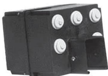
Il peut être monté n'importe où sur la ligne en correspondance avec la jonction de deux gaines. Il est équipé de presse-étoupes modulaires pour insérer le câble d'alimentation (diamètre câble jusqu'à 16 mm.) ; il est fixé à la gaine à l'aide de 2 vis et d'écrous M6.
