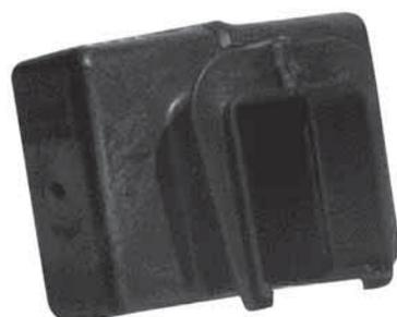
Serve a congiungere due tronchi di guaina laddove è prevista anche la giunzione dei conduttori. Viene utilizzata nel caso di prolungamenti di linee esistenti oppure nel caso di linee particolarmente lunghe, dove il conduttore non può essere inserito in un'unica soluzione. Viene fissata alla guaina in corrispondenza della giunzione utilizzando 2 viti e dadi M6.
