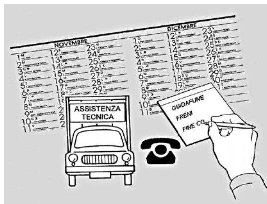
**UVIJEK** poštujte raspored radnji održavanja i pri svakoj provjeri bilježite sva zapažanja koja se odnose na kuku, uže, kočnice i granične sklopke.
