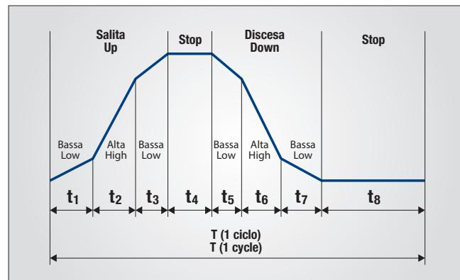
Il ciclo è costituito da periodi e arresti a bassa velocità e ad alta velocità. Nel caso di paranchi Dual Speed ER, la %ED è 40 (alta velocità) / 20 (bassa velocità). Pertanto, la sua %ED totale sarebbe 40%+20% = 60%ED.
