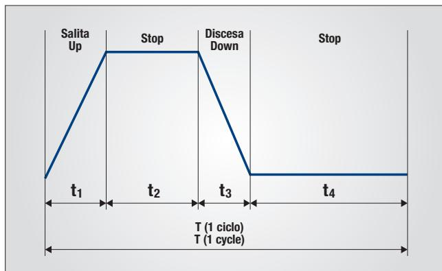
Il ciclo è composto da sollevamento/arresto/abbassamento e da un altro arresto di durata t<sub>4</sub> prima che il ciclo si ripeta. Il ciclo non è superiore a 10 min. Quando il paranco monovelocità opera in queste condizioni la temperatura del motore non supererà il massimo consentito. Un ciclo include 2 avviamenti motore %ED = (Tempo motore acceso (t<sub>1</sub>+t<sub>2</sub>)/T)\*100.
