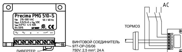
ВИНТОВОЙ СОЕДИНИТЕЛЬ 977-OP-DS/06 750V; 2,5 mm<sup>2</sup>; 24 A
